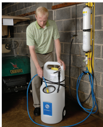
El sistema desionizador se usa para abastecer de agua a los cartuchos Hydrofill.
