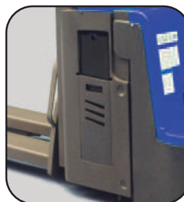
Batería de extracción lateral
