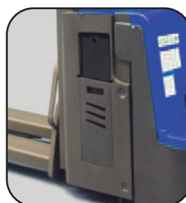
Batería de extracción lateral
